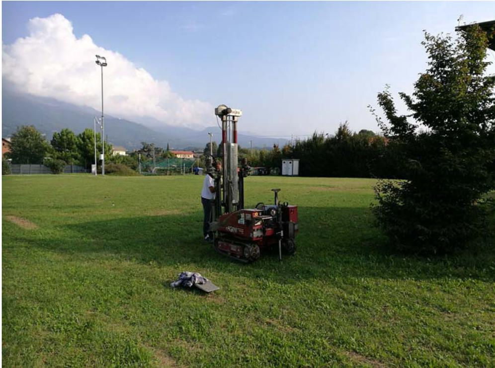
Foto 1 – 2: Esecuzione prova penetrometrica dinamica (sopra) e scavo SCI (sotto)
